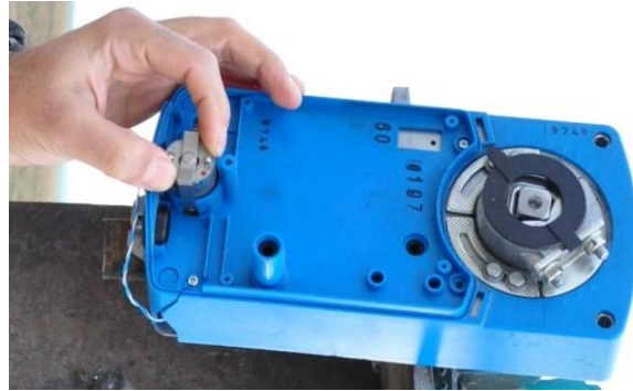
Şekil. 3. Redüktörlü sabit mıknatıslı DA motor görüntüsü (Damperli motor)
